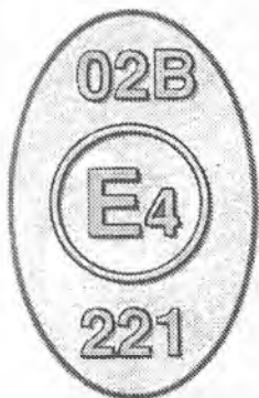
Рис. 8. Общий вид маркировочного обозначения, расположенного на поверхности противотуманных фар, соответствующих европейским требованиям.
