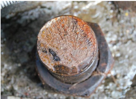
Рис. 1. Общий вид поверхности излома шпильки колеса легкового автомобиля, представленной на экспертное исследование
