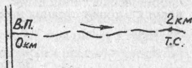
Рис. 39. Визначення точки стояння за відстанню
