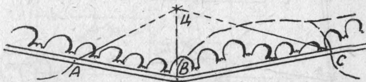
Рис. 45. Нанесення цілі на карту прямою засічкою
